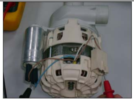
Mesure enroulement secondaire (câble bleu) 125 \Omega \pm 7 (NIDEC) 116 \Omega \pm 7 (WELLING)
